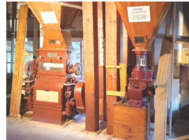
Komplett restaurierter Walzenstuhl und Grießauflöser
