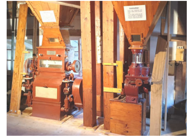
Komplett restaurierter Walzenstuhl und Grießauflöser
